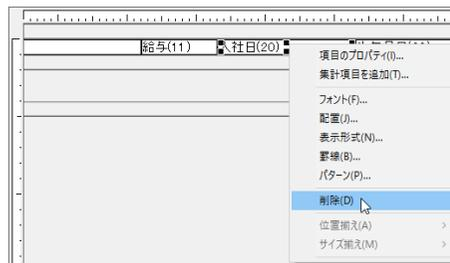
削除する項目を詳細フィールドから選択して Delete キーを押すか、項目を右クリックして表示されるメニューから [削除 (D)] を選択
